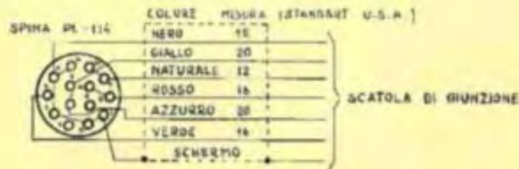
Fig. 18 - Cablaggio dei cavi CD-269, CD-270, CD-360, CD-411, CD-422, CD-444, CD-474
